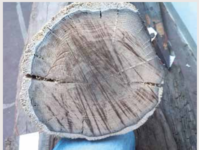
Abb. 2 Jahrringscheibe des selben Eichenpfehls. Der hellere Saum wird als Splintholz bezeichnet. Foto Werner
