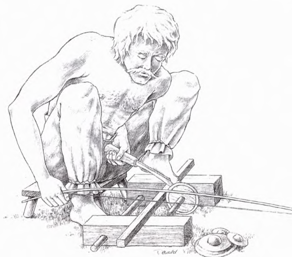
Abb. 19: Rekonstruktionszeichnung einer keltischen Drehbank
